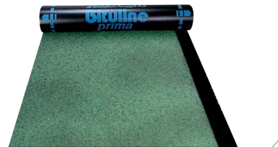
Bituline PP 40M (dereler ve detay çözümleri için granüle mineral kaplı TS EN 13707 standardında şalumo ile yapıştırılan polimer bitümlü membran)
